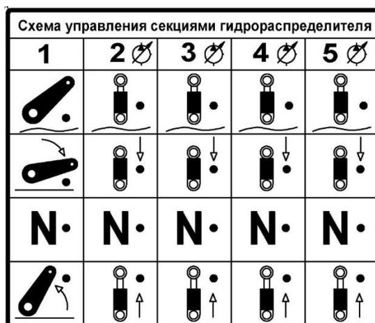
На тракторах с электроуправлением гидрораспределителя управление золотниками осуществляется от джойстиков 6 и 7, расположенных на панели управления справа от водителя. Каждый из четырех золотников, управляемых гидросистемой агрегатируемого орудия, имеет возможность регулировки времени срабатывания операции (таймер) и регулировки расхода масла через секцию.
