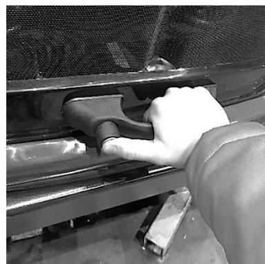
В процессе открывания следует придерживать капот за ремень для исключения рывков при порывах ветра.
