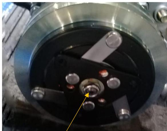
Прокрутить компрессор по часовой стрелке используя ключ с торцевой головкой 13 или 14 (в зависимости от установленного компрессора).
