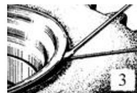
– вставить монтажные лопатки по обе стороны от вентиляционного отверстия на расстоянии 100 мм и, вдавливая ногами противоположный борт шины в монтажный ручей обода, извлечь часть борта шины за закраину обода;
