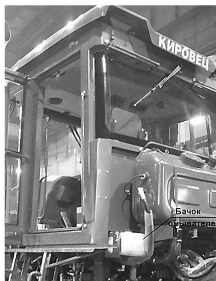
Для проверки работы омывателей заполнить бачок жидкостью для омывателей стекол в количестве 6 л и включить выключатель «массы». Последовательно включить омыватель передних и задних стекол. Включение переднего стеклоомывателя трактора производить нажатием на кольцо подрулевого переключателя в сторону рулевой колонки. Включение заднего стеклоомывателя производить включением клавиши в нижнее положение на потолочной панели кабины.
