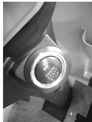
Кнопка имеет световую индикацию, непосредственно на кнопке, отображающую состояние работы электронного зажигания, а также звуковую сигнализацию, предупреждающую о невыполнении условий включения стартера.
