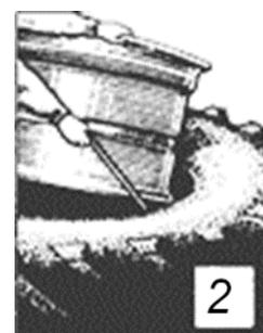
– для облегчения дальнейшего монтажа необходимо использовать вторую лопатку. Вставить её между бортом шины и ободом и отжать обод вверх, другую лопатку вставить ближе к заведённому борту шины и повторить предыдущую операцию;
