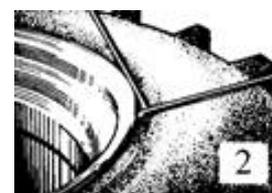
– первой монтажной лопаткой отжать борт шины вниз. Операции пунктов 1, 2, 3 повторить по всей окружности обода до полного снятия бортов шины с посадочных полок;
