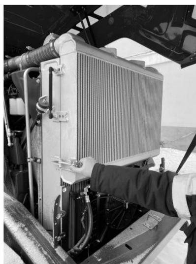
Потянуть радиатор охлаждения наддувочного воздуха на себя. В открытом положении его будут удерживать газовые пружины, расположенные с обеих сторон.
