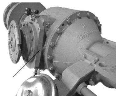
Серийный номер моста выбит на шильде, закрепленной на корпусе главной передачи (**мосты серии Т400**).
