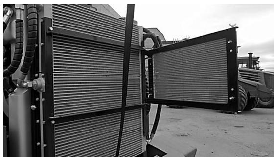
После очистки конденсатора кондиционера установку его осуществить в обратной последовательности. Весь процесс без учёта очистки ячеек радиатора занимает 1,5-2 мин.
