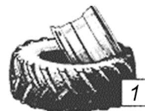
– вставить первую лопатку между верхним бортом шины и ободом так, чтобы изогнутый конец надёжно захватил борт шины, и, действуя как рычагом, завести монтируемый борт шины за закраину обода. Эту операцию повторить несколько раз до тех пор, пока заведение монтируемого борта не будет вызывать затруднений;
