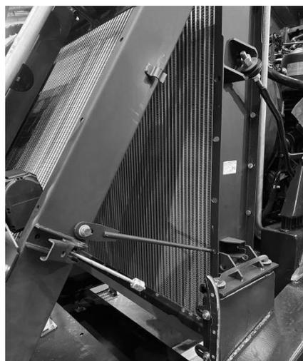
После очистки привести блок радиаторов в исходное положение в обратном порядке. Весь процесс без учёта очистки блока радиаторов занимает 3 мин.
