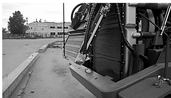
После очистки привести блок радиаторов в исходное положение в обратном порядке. Весь процесс без учёта очистки блока радиаторов занимает 3 мин.
