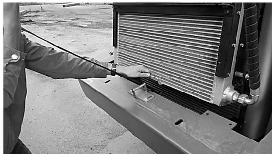
Зафиксировать блок радиаторов с помощью упора.
