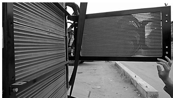
Продувку ячеек кондиционера осуществлять в направлении противоположном потоку воздуха.
