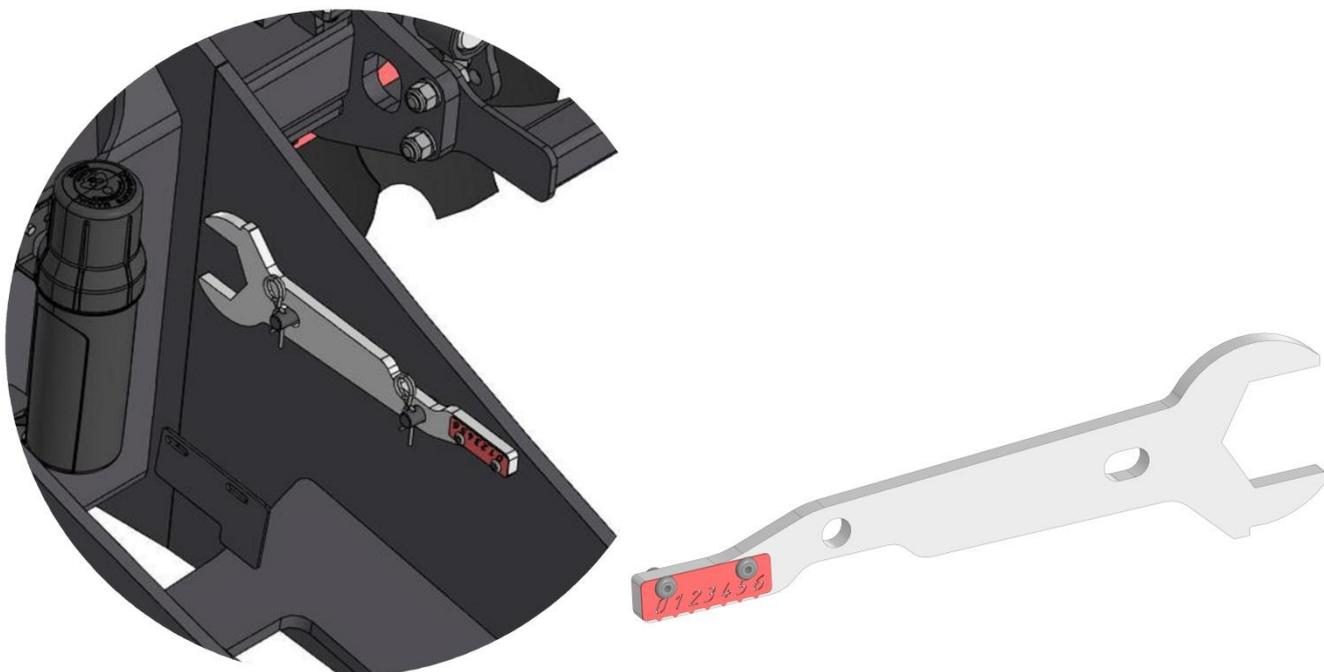
Рисунок 37 – Спецключ, закрепленный на прицепном устройстве
