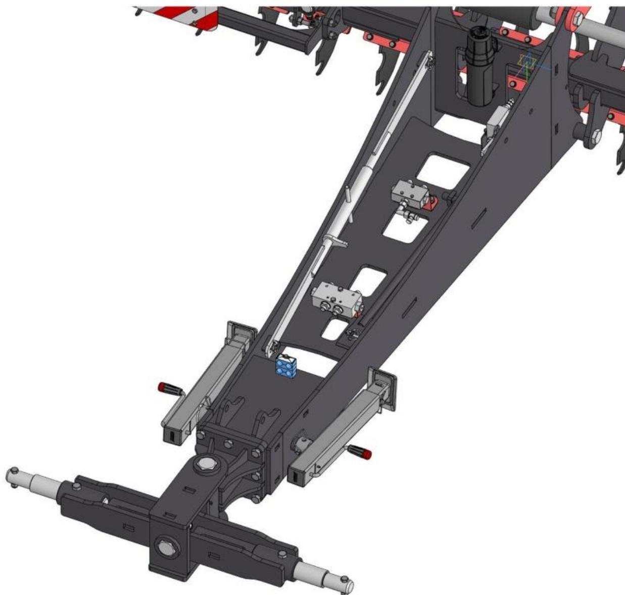
Рисунок 28 – Снятие страховочной растяжки
