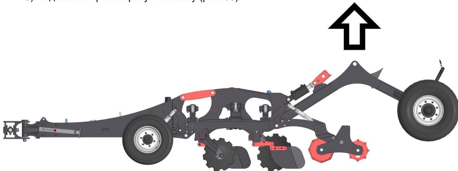
Рисунок 33 – Поднятие транспортной тележки
