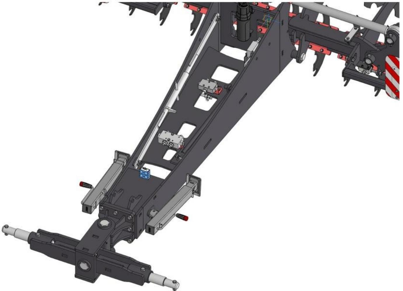
Рисунок 27 – Установка страховочной растяжки
